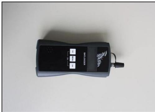
Abbildung 2: Handdetektor Batlogger
