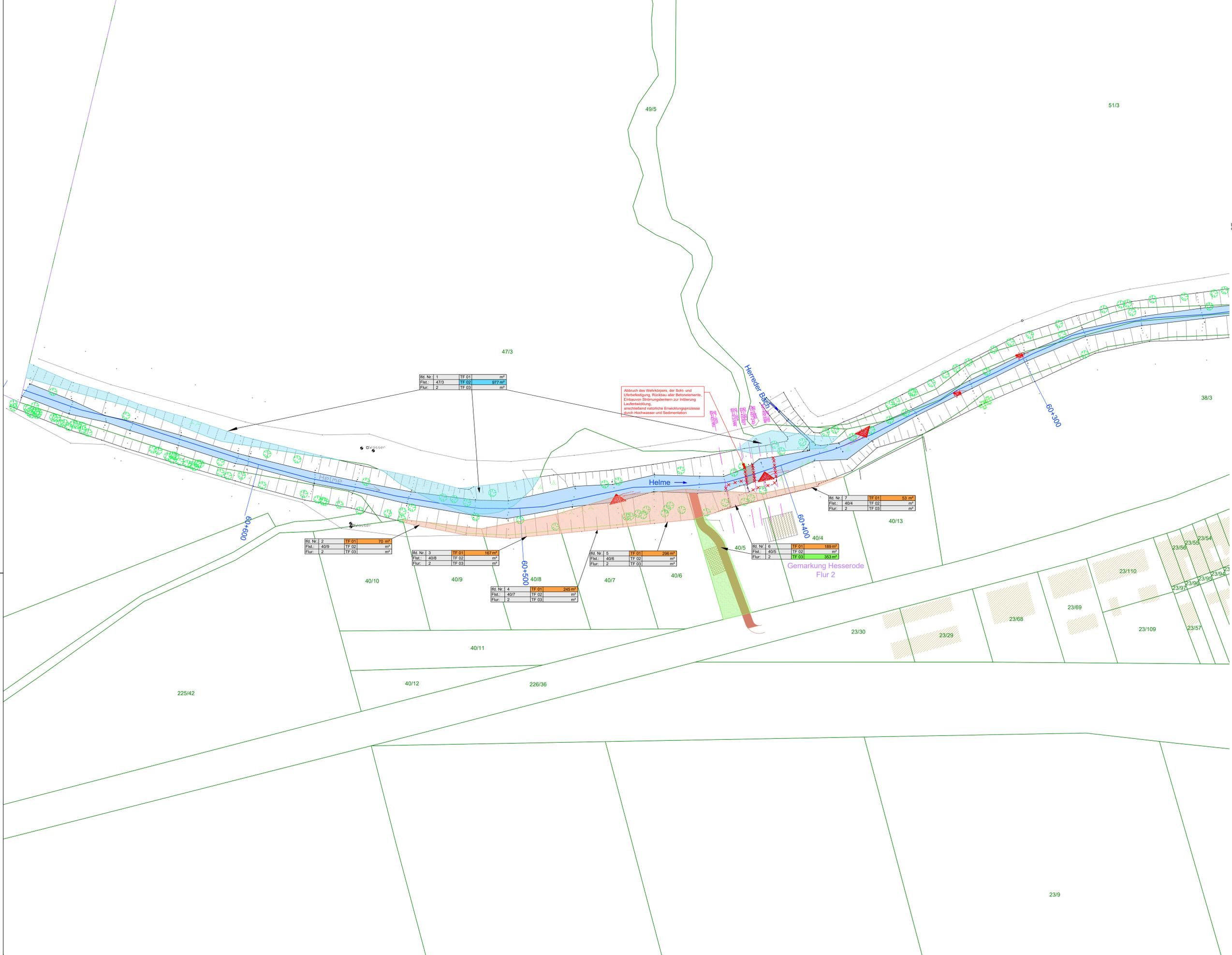
Abbruch des Wehrkörpers, der Sohle- und Uferbefestigung, Rückbau aller Betonlemente, Einbau von Strömunglenkern zur Sicherung Laufentwicklung, anschließend natürliche Entwicklungsprozesse durch Hochwasser und Sedimentation
