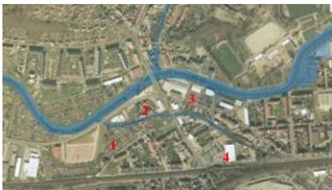
1. Es wird deutlich, dass kurz nach Ansteigen der Wasserstände der Hörsel der Rückstau in den Mühlgraben und den Roten Bach beginnt.
